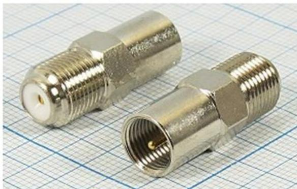
Переходник предназначен для стыковки кабелей и приборов, имеющих соответствующие ответные части разъемов FME и F-типа. Переходник имеет позолоченный центральный проводник и хромированный корпус. Изолятор, как правило, изготовлен из фторопласта.
