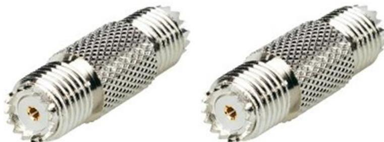
Переходник предназначен для стыковки кабелей и приборов, имеющих соответствующие ответные части ВЧ разъемов стандарта mini-UHF. Переходник имеет позолоченный центральный проводник и хромированный корпус. Изолятор, как правило, изготовлен из фторопласта.
