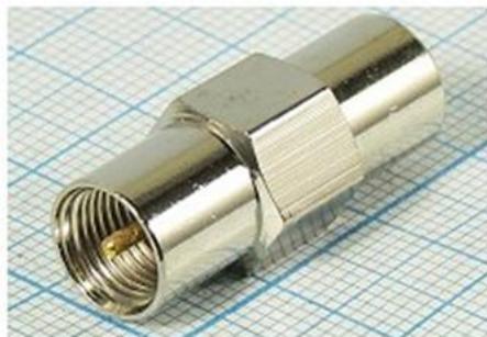
**Переходник предназначен длястыковки кабелей и приборов, имеющих соответствующие ответные части разъемов FME. Переходник имеет позолоченный центральный проводник и хромированный корпус. Изолятор, как правило, изготовлен из фторопласта.**
