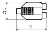
Возможны варианты различного покрытия контактов разъема: позолоченные, никелированные и т.д.
