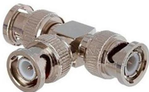
**Переходник предназначен для стыковки кабелей и приборов, имеющих соответствующие ответные части ВЧ разъемов стандарта BNC. Переходник имеет позолоченный центральный проводник и хромированный корпус. Необходимо помнить, что наименьшие потери сигнала и лучшее согласование, достигается при подключении одного потребителя (одной нагрузки) к источнику сигнала. При подключении двух (и более) нагрузок, для предотвращения потери сигнала, необходимо применять цепи согласования.**
