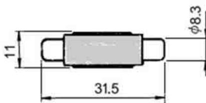
**Возможны варианты различного покрытия контактов разъема: позолоченные, никелированные и т.д. Адаптер предназначен для наращивания длины кабелей и коммутации различных аудиоустройств, имеющих ответные разъемы стандарта RCA (штекера).**
