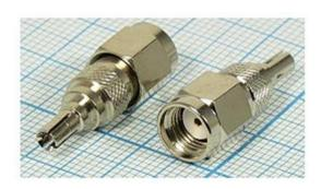
Переходник предназначен для стыковки кабелей и приборов, имеющих соответствующие ответные части ВЧ разъемов стандарта SMA-RP и CRC9. Переходник имеет позолоченный центральный проводник и никелированный (хромированный) корпус. Изолятор, как правило, изготовлен из фторопласта.
