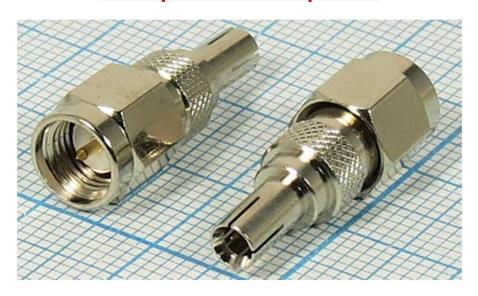
Переходник предназначен для стыковки кабелей и приборов, имеющих соответствующие ответные части ВЧ разъемов стандарта SMA и TS-9. Переходник имеет позолоченный центральный проводник и никелированный (хромированный) корпус. Изолятор, как правило, изготовлен из фторопласта.
