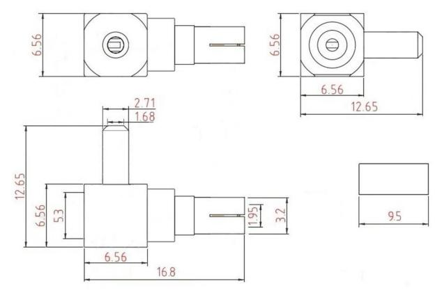
Центральный проводник разъема позолоченный, корпус никелированный (хромированный). Изолятор, как правило, изготовлен из фторопласта.
