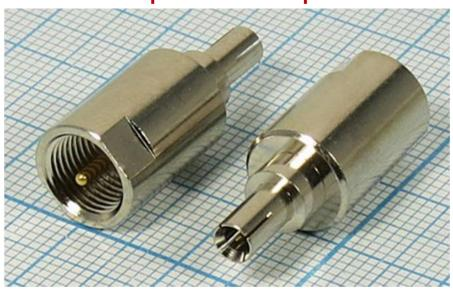
Переходник предназначен для стыковки кабелей и приборов, имеющих соответствующие ответные части ВЧ разъемов стандарта FME и TS-9. Переходник имеет позолоченный центральный проводник и никелированный (хромированный) корпус. Изолятор, как правило, изготовлен из фторопласта.
