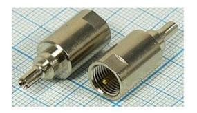
Переходник предназначен для стыковки кабелей и приборов, имеющих соответствующие ответные части ВЧ разъемов стандарта FME и CRC9. Переходник имеет позолоченный центральный проводник и хромированный корпус. Изолятор, как правило, изготовлен из фторопласта.
