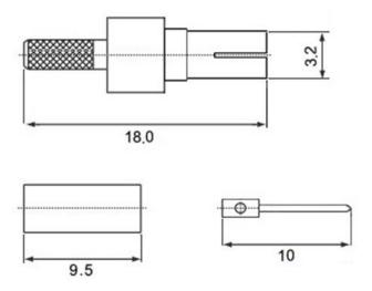
Центральный проводник разъема позолоченный, корпус никелированный (хромированный). Изолятор, как правило, изготовлен из фторопласта.
