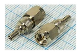
Переходник предназначен для стыковки кабелей и приборов, имеющих соответствующие ответные части ВЧ разъемов стандарта SMA-RP и CRC9. Переходник имеет позолоченный центральный проводник и никелированный (хромированный) корпус. Изолятор, как правило, изготовлен из фторопласта.
