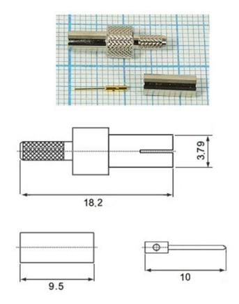
Центральный проводник разъема позолоченный, корпус никелированный (хромированный). Изолятор, как правило, изготовлен из фторопласта.
