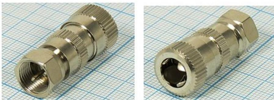
**Разъемы предназначены для быстрого монтажа без применения пайки. Крепление центрального проводника производится винтом, оплетка кабеля обжимается. Центральный контакт и корпус разъема никелированы. Изолятор изготовлен из фторопласта.**
