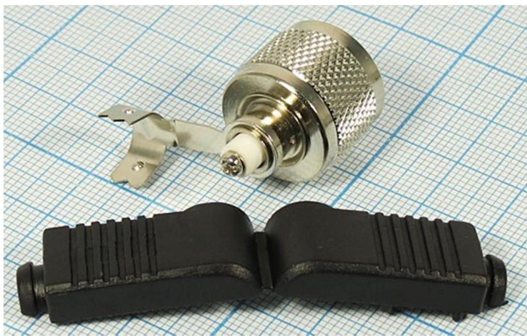
**Разъемы предназначены для быстрого монтажа без применения пайки. Крепление центрального проводника производится винтом, оплетка кабеля обжимается. Возможно применение различных коаксиальных кабелей с внешним диаметром оболочки до 6 мм.**
