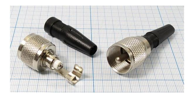
Разъемы предназначены для быстрого монтажа без применения пайки. Крепление центрального проводника производится винтом, оплетка кабеля обжимается. Возможно применение различных коаксиальных кабелей с внешним диаметром оболочки до 6 мм.
