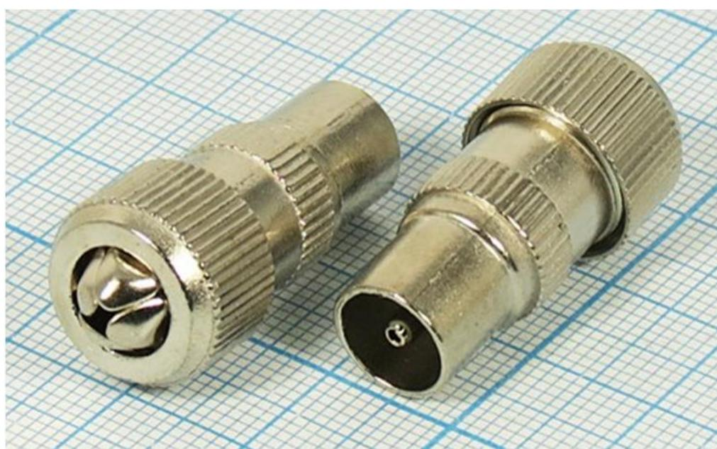
**Разъем предназначен для быстрого монтажа без применения пайки. Центральная жила кабеля крепится винтом, оплетка кабеля (экран) обжимается цанговым зажимом.**
