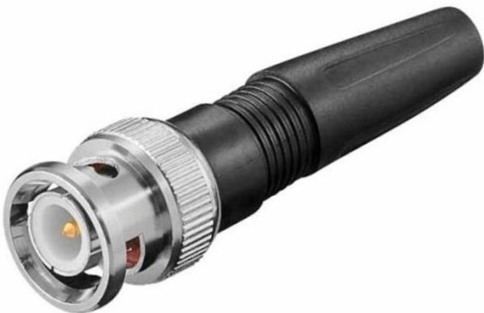
Разъемы предназначены для быстрого монтажа без применения пайки. Крепление центрального проводника производится винтом, оплетка кабеля обжимается. Возможно применение различных коаксиальных кабелей с внешним диаметром оболочки 6 мм. Пятидесятиомные версии разъемов этой серии работают до 11 ГГц.
