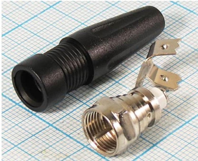
Разъемы предназначены для быстрого монтажа без применения пайки. Крепление центрального проводника производится винтом, оплетка кабеля обжимается. Возможно применение различных коаксиальных кабелей с внешним диаметром оболочки до 6 мм. Центральный контакт разъема и корпус никелированы, материал изолятора – фторопласт (полиэтилен или полистирол).
