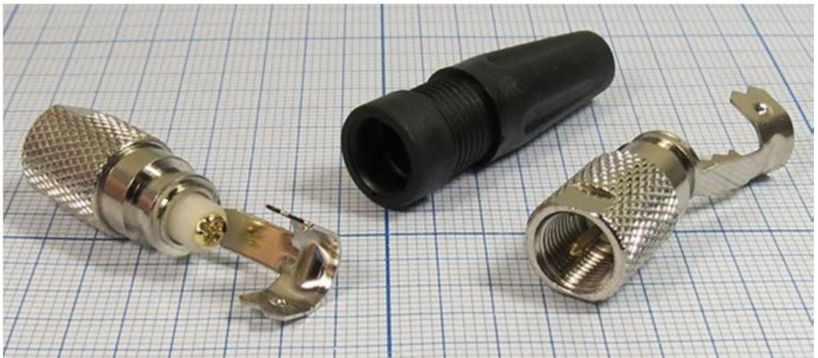
**Разъемы предназначены для быстрого монтажа без применения пайки. Крепление центрального проводника производится винтом, оплетка кабеля обжимается. Возможно применение различных коаксиальных кабелей с внешним диаметром оболочки 6 мм. Разъем имеет никелированный центральный проводник и хромированный корпус. Изолятор, как правило, изготовлен из фторопласта.**
