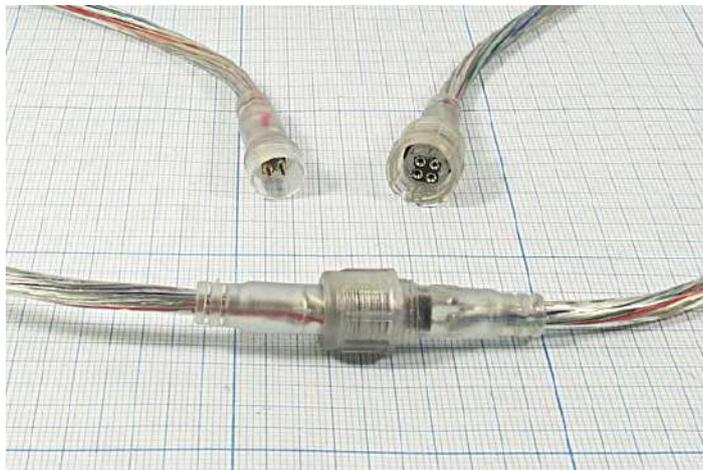
Герметичные разъемы марки F/M 22AWG\*4pins L170mm находят широкое применение во всех областях электронной промышленности, медицинской технике, телекоммуникациях, машиностроении. Герметичность реализована на основе применения уплотнительных водонепроницаемых материалов. Разъемы имеют степень защиты IP65, что дает возможность использовать их на улице при повышенной влажности.
