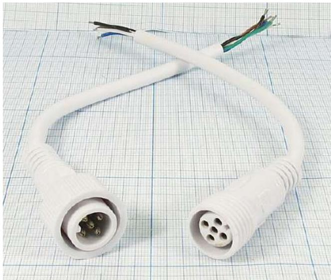
Герметичные разъемы марки 5pin WP L=40 D=21.5mm 5\*0.2mm<sup>2</sup> находят широкое применение во всех областях электронной промышленности, медицинской технике, телекоммуникациях, машиностроении. Герметичность реализована на основе применения уплотнительных водонепроницаемых материалов. Разъемы имеют степень защиты IP65, что дает возможность использовать их на улице при повышенной влажности.
