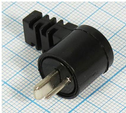
DIN-разъём для акустических систем, называемый также «точка-тире». Поляризованный двухконтактный неэкранированный разъём, разработанный для подключения громкоговорителя к усилителю мощности звуковой частоты или другому устройству. Он существует в виде гнезда для монтажа на панель. Гнезда или штекера на кабель. Круглый контакт подключается к положительному полюсу (красный), а плоский — к отрицательному (чёрный).
