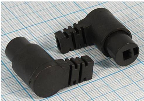
DIN-разъём для акустических систем, называемый также «точка-тире». Поляризованный двухконтактный неэкранированный разъём, разработанный для подключения громкоговорителя к усилителю мощности звуковой частоты или другому устройству. Он существует в виде гнезда для монтажа на панель. Гнезда или штекера на кабель. Круглый контакт подключается к положительному полюсу (красный), а плоский — к отрицательному (чёрный).
