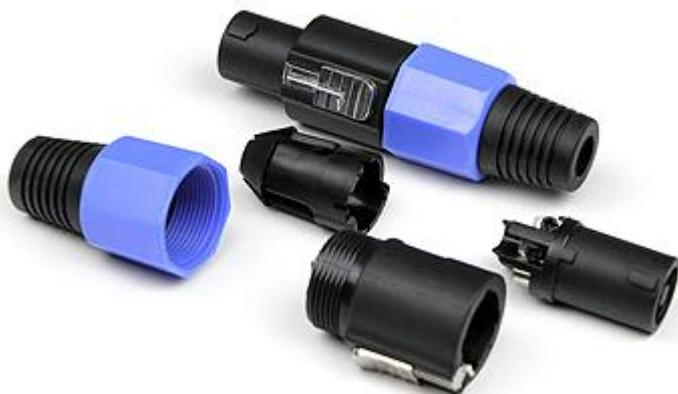
Разъемы Speakon (Спикон) - тип кабельных разъемов используемых в профессиональных аудио технических системах для подключения акустических систем к усилителям мощности. Кабельный разъем типа Speakon штекер, четырёх контактный для низковольтных соединений с высокими значениями токов (до 40А), так же подходит для подключения к микшерам и для соединения между собой акустических систем.
