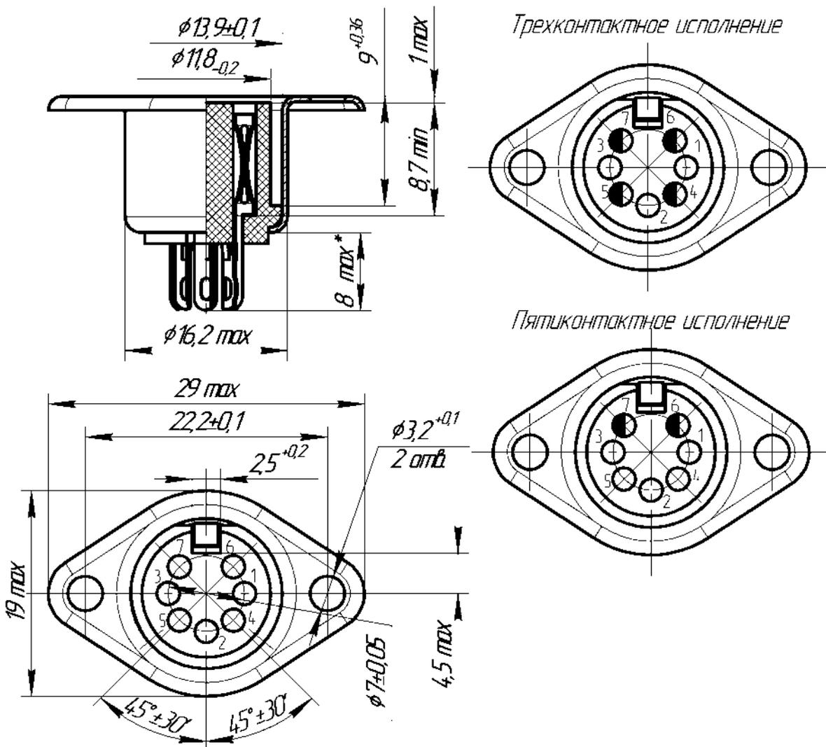
Примечание. В трехконтактной и пятиконтактной розетке в отверстия контакты не закладываются.
