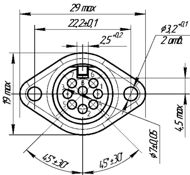
Примечание. В трехконтактной, пятиконтактной и семиконтактной розетке в отверстия
