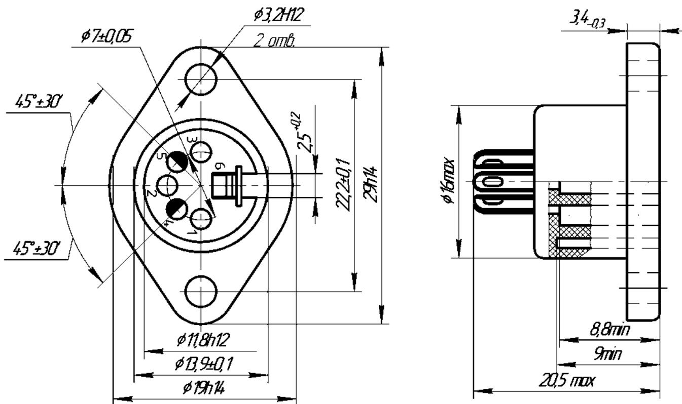
Примечание: В трёхконтактной розетке в отверстия контакты не закладываются. Контакты размыкателя нормально замкнуты. Оцифровка контактов дана условно.
