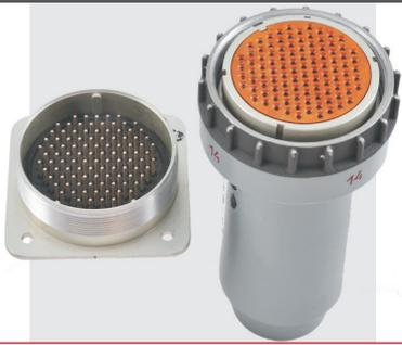
Соединители PPM47 предназначены для работы в электрических цепях постоянного, переменного (частотой до 3 МГц) токов при напряжении 300 В (амплитудное значение).
