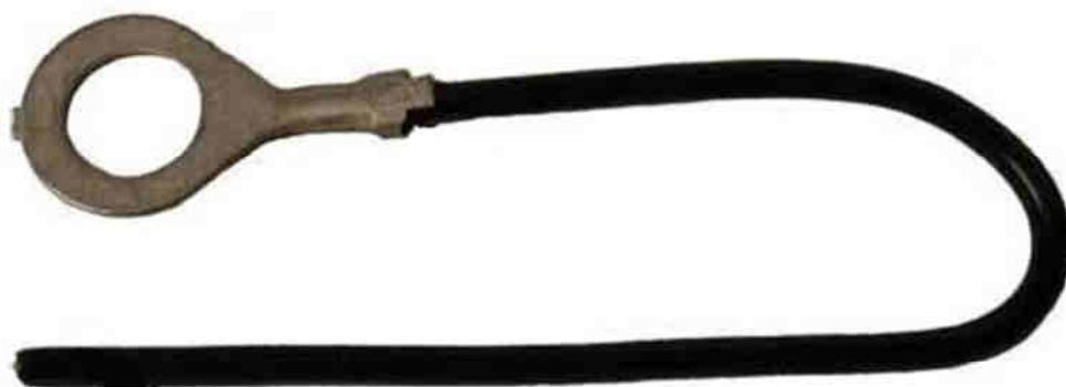
**Предназначена для подключения с соединениями типа «под болт». Сечение 0,75 мм.кв, длина 110 мм. Исполнение по проводу – в пяти вариантах цветов. Применение: универсальна, возможна установка в любых цепях постоянного тока до 48 вольт.**
