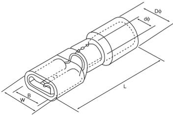
поперечное сечение провода 4~6mm² I<sub>max</sub>=24A
