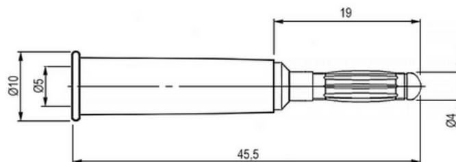
Цвет изолятора может иметь самую разнообразную цветовую гамму. Покрытие контактной части чаще никелированное или позолоченное.
