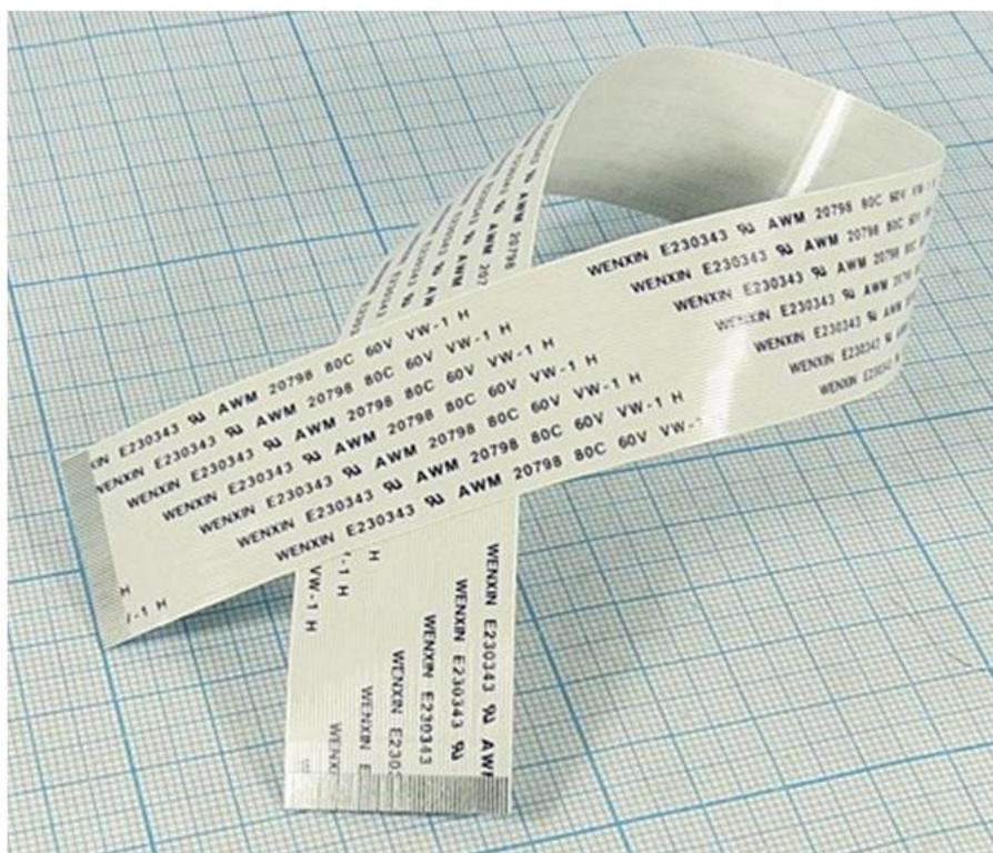
Шлейф представляет из себя гибкий соединитель длиной 300 мм и шириной 25 мм. Количество контактов 49, шаг 0,5 мм.
