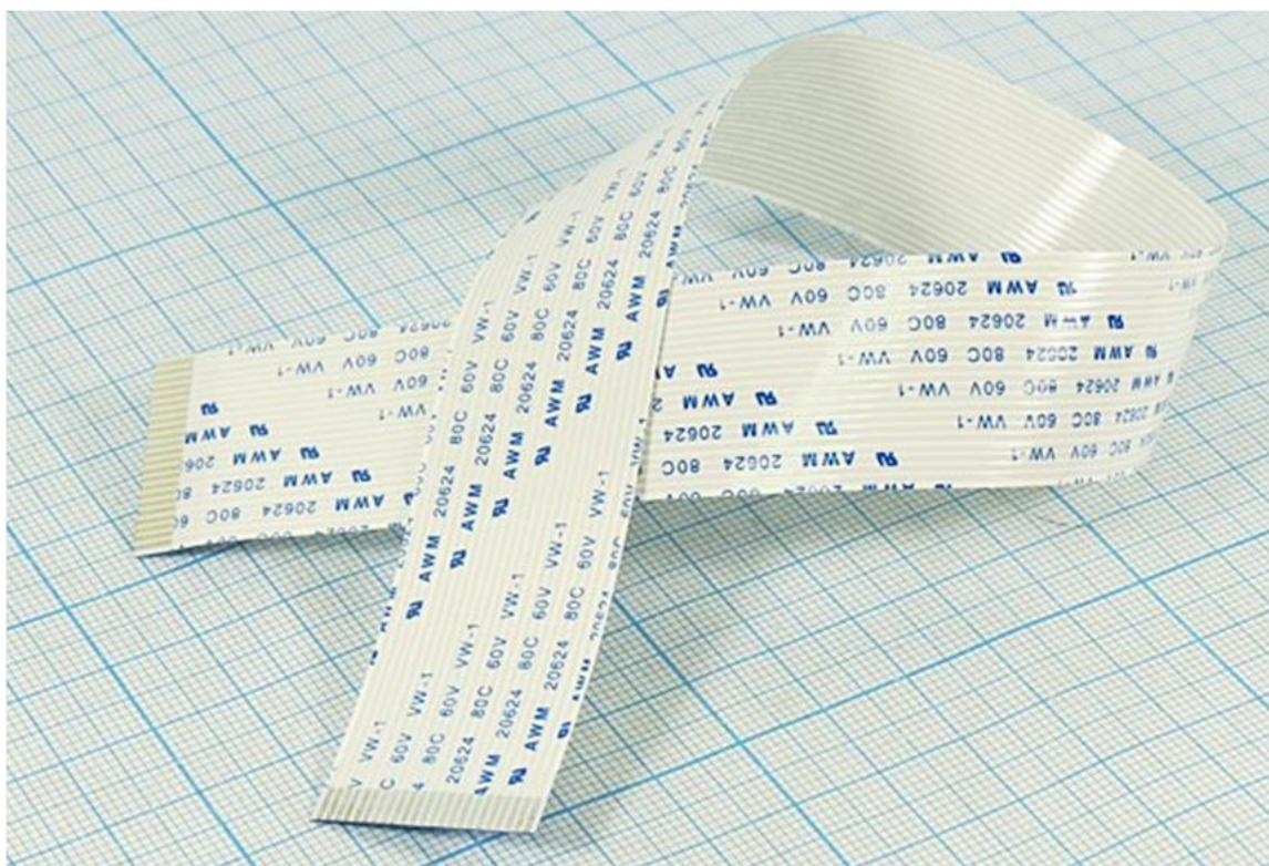
**Шлейф представляет из себя гибкий соединитель длиной 300 мм и шириной 24 мм. Количество контактов 23, шаг 1 мм.**
