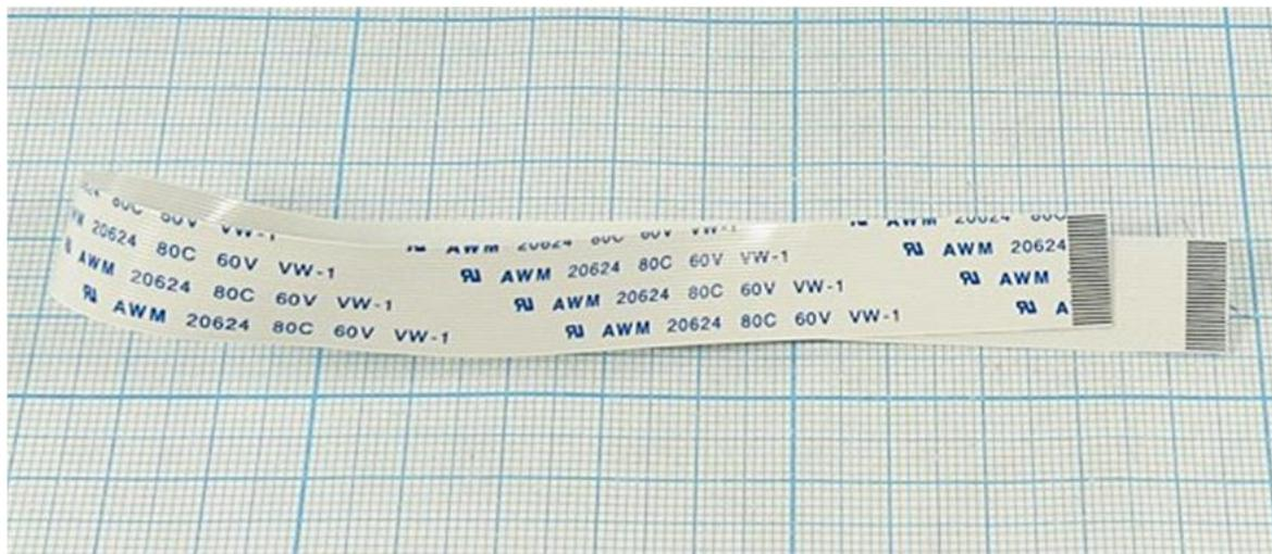
Шлейф представляет из себя гибкий соединитель длиной 250 мм и шириной 12,5 мм. Количество контактов 24, шаг 0,5 мм.
