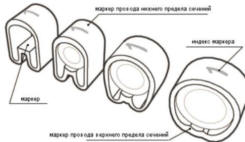
Кабельные маркеры Энергия серии МК применяются для маркировки различных кабелей и проводов. Предназначены для облегчения идентификации проводов в момент монтажа/демонтажа. Материал изготовления маркеров - поливинилхлорид, который позволяет добиться устойчивости к щелочи, маслам, растворителям и т.д., а также позволяет добиться высокой эластичности, что в значительной степени облегчает задачу монтажника в момент прокладки электропроводки. В ассортименте имеются цифровые символы от “0” до “9”.
